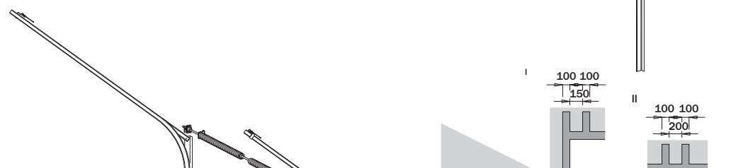
**CZ** Varianta pro montáž 4 pružin (od šířky vrat 4 251mm)
