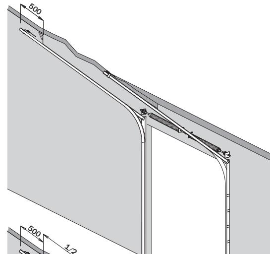
**CZ** Do výšky vrat 4 000mm nebo plochy vrat větší jak 12m<sup>2</sup>, je potřeba min. dvou horizontálních ukotvení u každé kolejnice.
