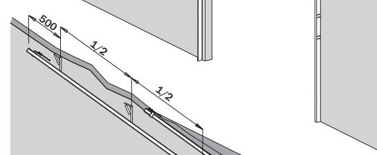
**CZ** Nad výšku vrat 4 000mm nebo plochy vrat větší jak 20m<sup>2</sup>, je potřeba min. tří horizontálních ukotvení u každé kolejnice.
