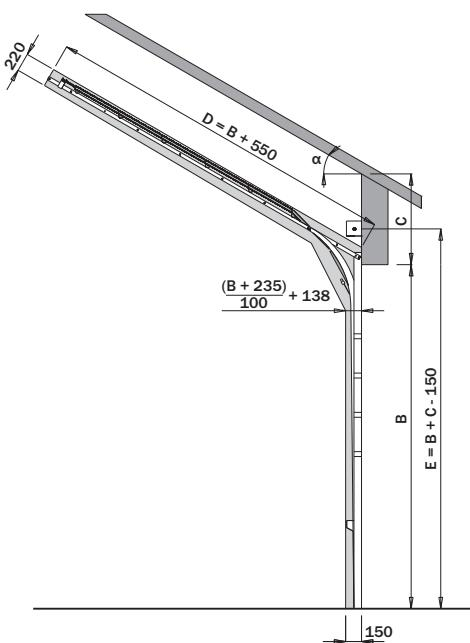
**CZ A** - šířka otvoru (od šířky vrat 4 950mm je nutno připočítat váhu vzpěr, počet vzpěr se rovná počtu sekcí, váha vzpěr 1,25kg/bm, váha sekci 12 kg/m<sup>2</sup>)
